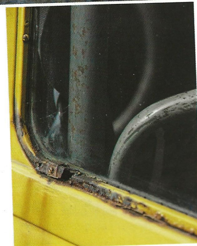
La rouille a fait son œuvre par endroits, mais la carrosserie dans son jus est encore très saine. Notez le renfort tubulaire de caisse monté à posteriori, en 1972 pour le Pop'Cross d'Argenton-sur-Creuse. Ci-dessous quelques stickers de souvenirs de voyages : le Cercle polaire Arctique et la Mondiale 2 CV en Espagne en 2013.
