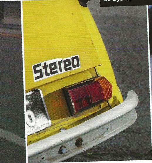
Avant le départ du raid l'éclairage de la 2 CV PO de 1955 a été adapté, avec notamment ces feux arrière de Dyane.
