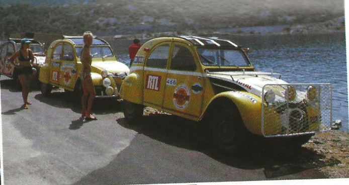
Avant le départ du raid l'éclairage de la 2 CV PO de 1955 a été adapté, avec notamment ces feux arrière de Dyane.
